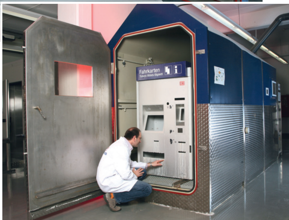
Bild 3. Prüfung eines Ticketautomaten auf Korrosion
