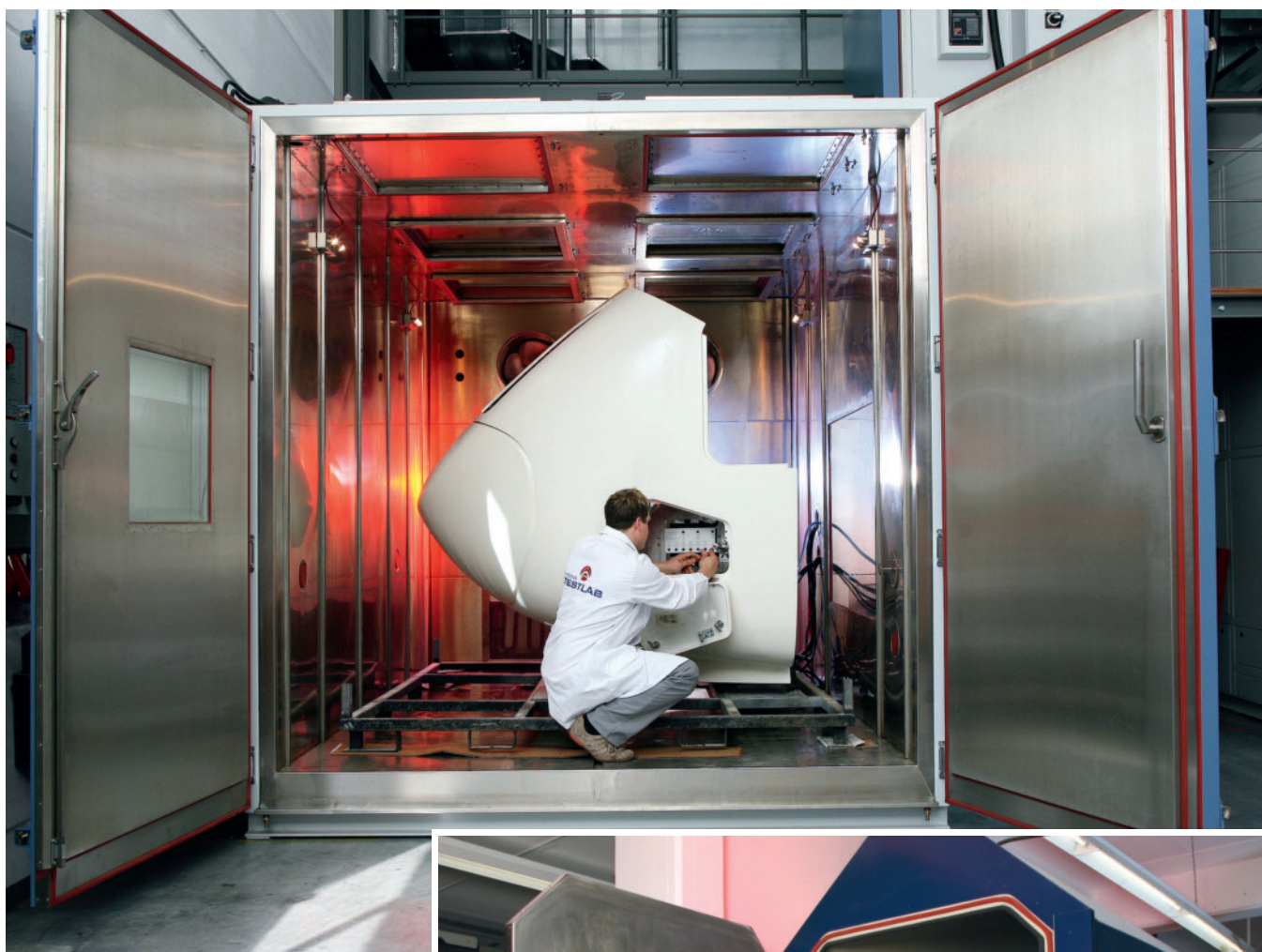
Bild 2. Prüfung einer Bugklappensteuerung in einer Klimakammer
